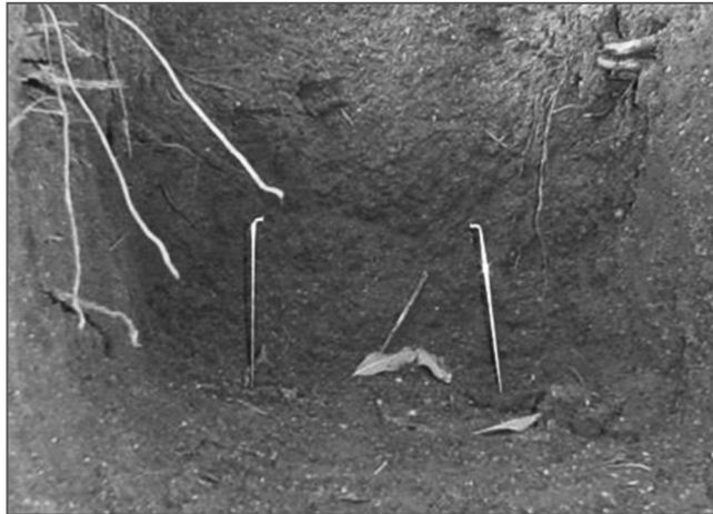
Figura 8. Fotografía general posición clavos de erosión.
