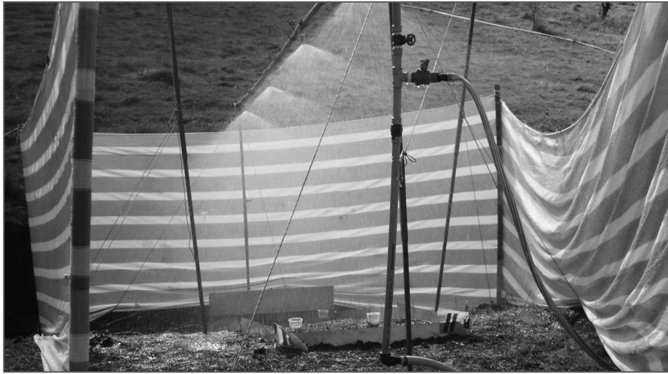
Figura 3. Simulador de lluvia funcionando sobre una parcela de 37 % de pendiente.
