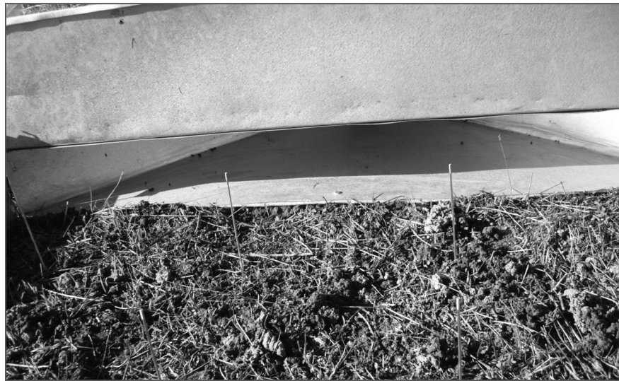
Figura 8. Superficie de la parcela y el colector de escorrentía instalado
