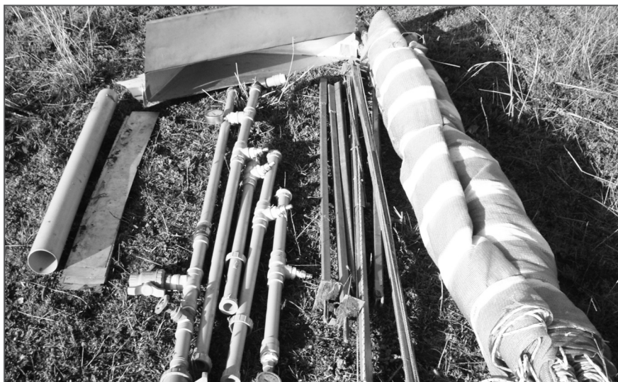
Figura 7. Componentes de la estructura del simulador de lluvia
