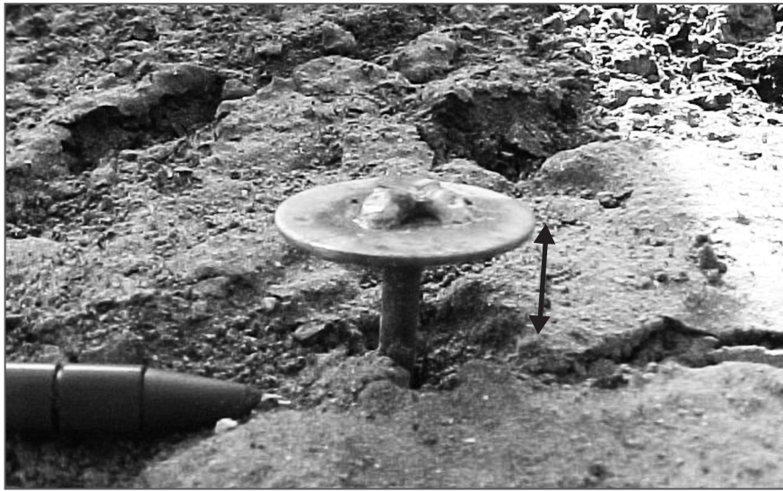
Figura 6. Los clavos de erosión son utilizados para medir cambios en la superficie del suelo. La fotografía, tomada por Pablo García-Chevesich, muestra un clavo de erosión en areniscas de Arizona, después del incendio forestal Rodeo-Chediski. Nótese que hay evidencia de erosión, producida por las lluvias invernales.
