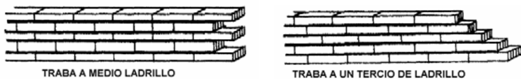
Fig.12 Trabas comunes de los ladrillos en muros.
