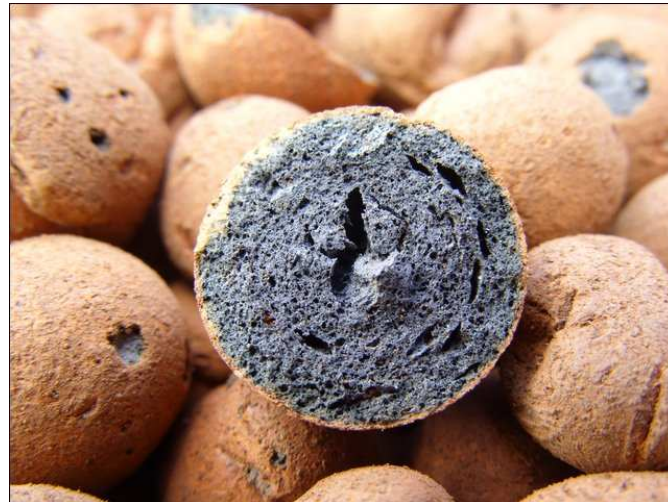
Imagen 1. Corte transversal de un gránulo de arcilla expandida. En el interior puede observarse la estructura interna porosa de volúmenes irregulares que permite el alojamiento de las esporas y el lactato cálcico de manera homogénea, ocupando el volumen disponible mediante un proceso de impregnado previo a la adición del árido a la mezcla cementosa
