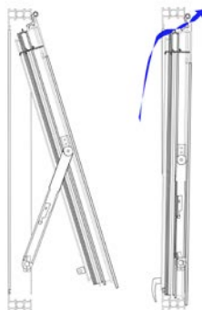
Figura 4.14: Aberturas generadas por los diferenciales de presión asociados a los mecanismos de cierre y descuadres en ventanas.
