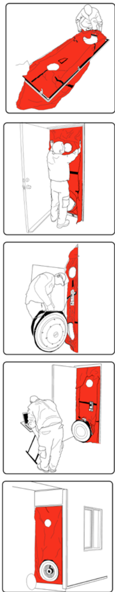
Figura 4.7: Proceso de instalación equipamiento de ensayo.
