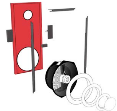
Figura 4.11: Anillos para controlar el área de apertura del ventilador, Equipo Q4E Blower Door Retrotec.
