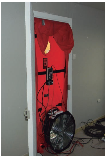
Figura 2.2: Equipo Standard Model 3 Minneapolis en funcionamiento.
