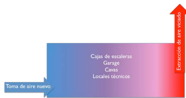
Figura 9.9: Esquema de circulación flujos de aire edificios de servicios
