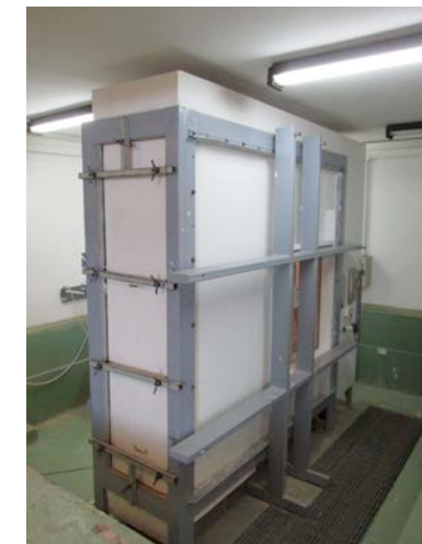
Figura 6.6: Vista lateral de la cámara de infiltración del Laboratorio de Física de la Construcción de CITEC UBB.
