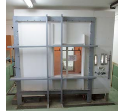
Figura 6.5: Cámara de infiltración del Laboratorio de Física de la Construcción de CITEC UBB con ventana instalada.
