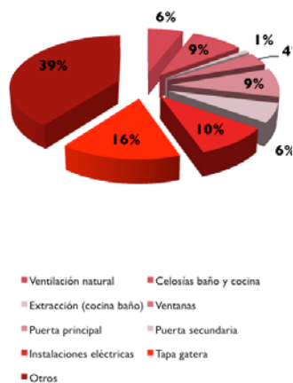
Figura 5.10: Incidencia de puntos singulares a la hermeticidad al aire en sistema mixto.
