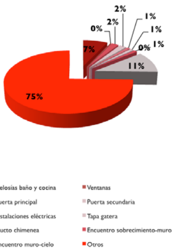
Figura 5.11: Incidencia de puntos singulares a la hermeticidad al aire en sistema liviano.
