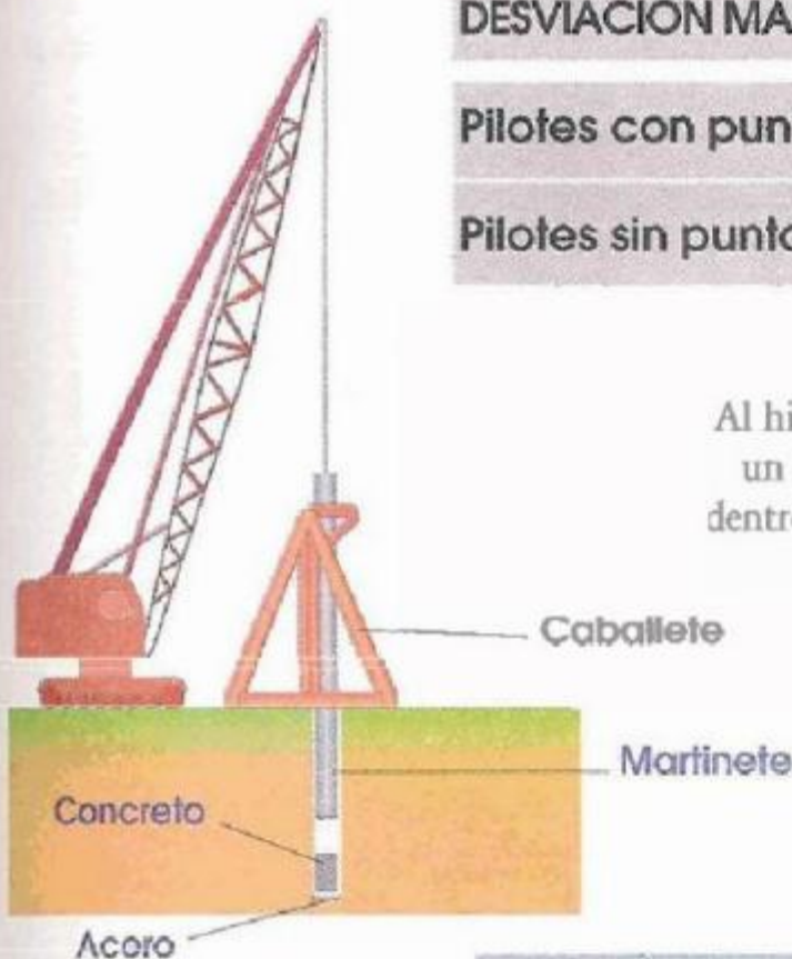
Hinca del pilote
