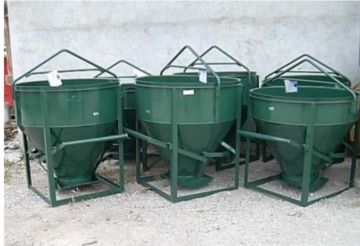
Cubilote de vertido de hormigón
