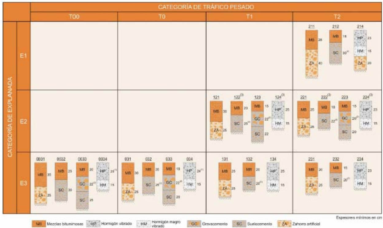
Catálogo de secciones de firme para las categorías de tráfico pesado T0 a T2, en función de la categoría de explanada
