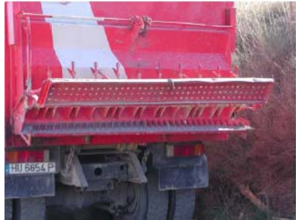
Camiones dumpers dotados de utensilio especial llamado gravilladora para repartir las gravillas artificiales
