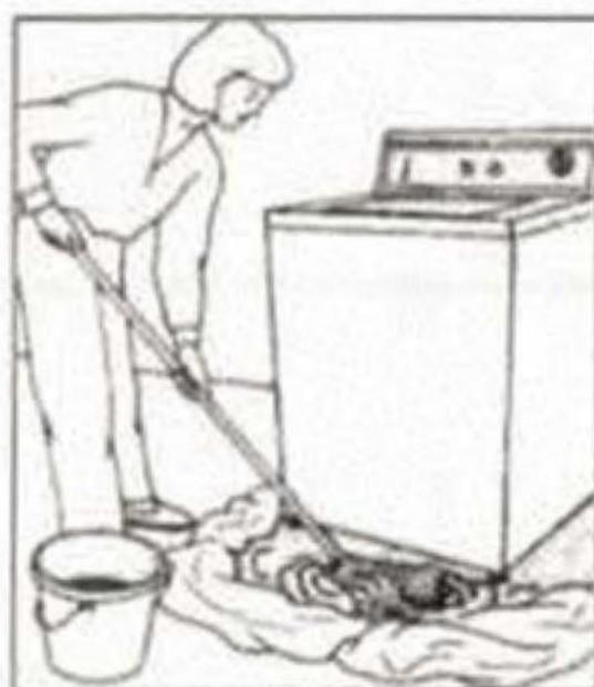
3.- SE CORTA LA ALIMENTACIÓN ELÉCTRICA DE UN ELECTRODOMÉSTICO Y SE SECA CUALQUIER FUGA O HUMEDAD EN EL MISMO
