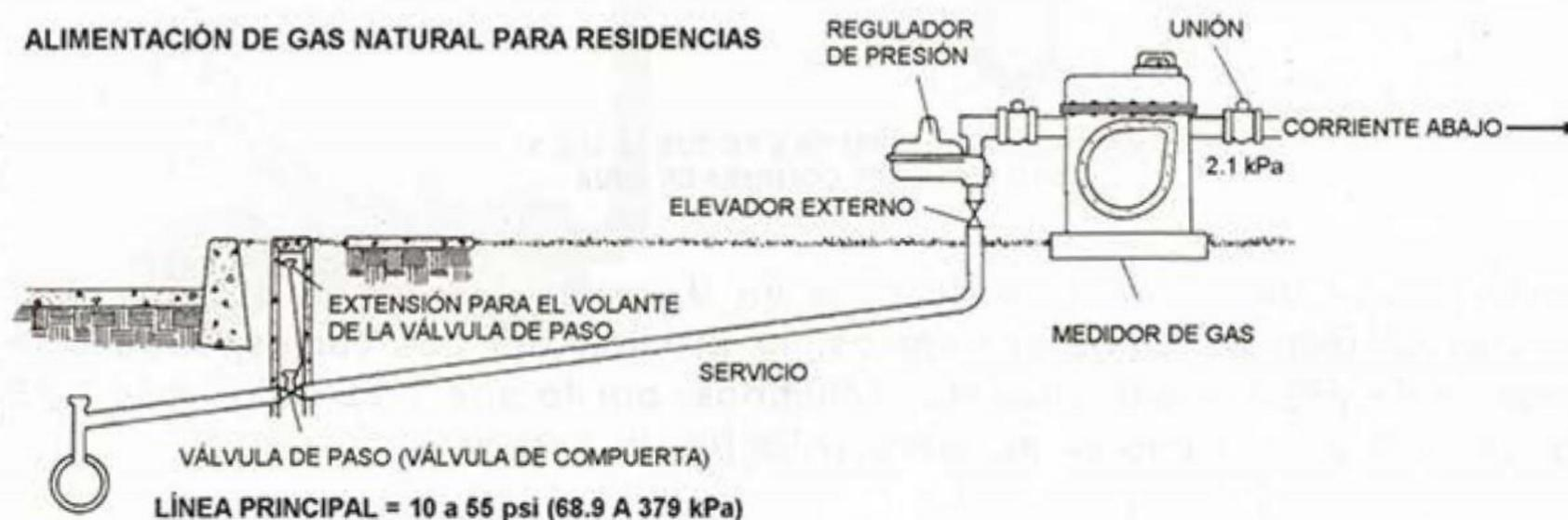
Los reguladores normalmente se ajustan en la fábrica de acuerdo con las especificaciones del fabricante del aparato; sin embargo, cuando es necesario, se pueden regular conectando un manómetro en la toma de la
