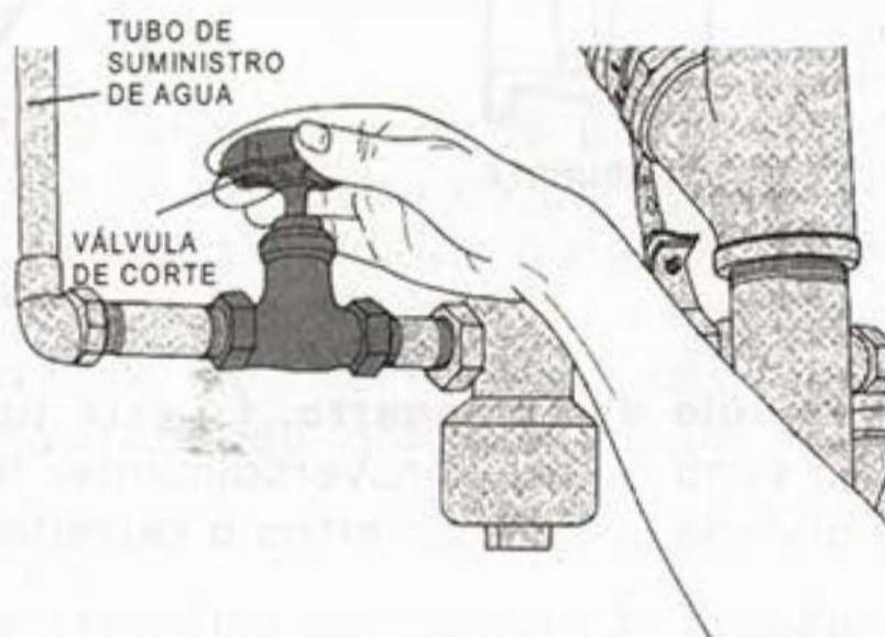
TODAS LAS INSTALACIONES HIDRÁULICAS EN CASAS-HABITACIÓN CUENTAN CON VÁLVULA DE CORTE DEL SUMINISTRO PRINCIPAL DEL AGUA, QUE SIRVE PARA CORTAR TOTALMENTE LA ALIMENTACIÓN EN CASO DE FUGAS O REPARACIONES A LA INSTALACIÓN.
