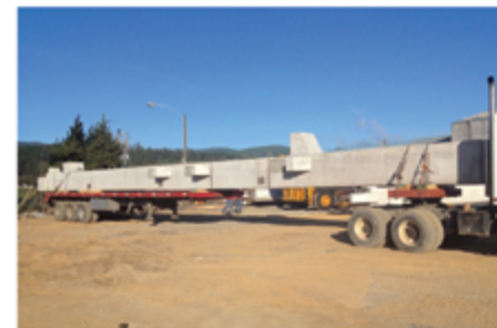
05 Traslado Pilares 26 mts. / 59 Ton.
