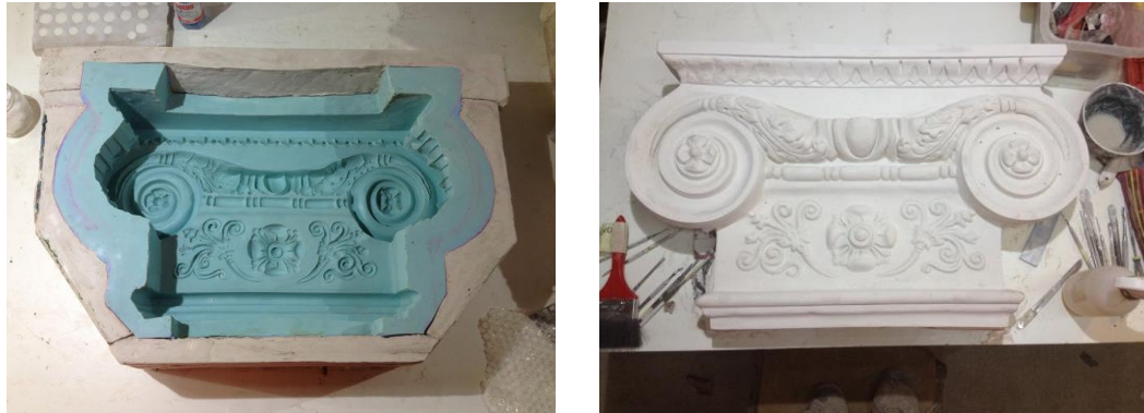
Imagen 21: Castro, F. 2017. Molde definitivo y reproducción definitiva de capitel jónico ORE3. Fotografía. Archivo personal.
