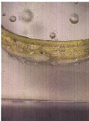
Imagen 28: LARCO QUÍMICA Y ARTE S.L. 2016. ME-04, capas superiores (pintura) 30X. Fotografía. Recuperado de: Análisis químico y petrológico de muestras de materiales pétreos procedentes del Palacio Pereira y edificios CMN Y DIBAM (Santiago de Chile).
