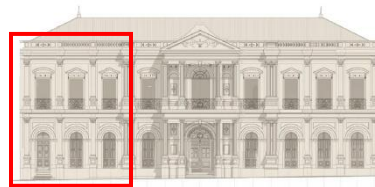
Plano 6: KALAM. 2017. Levantamiento de zonas de retiro de estucos y ornamentos. Huérfanos, etapa 3. Plano. Recuperado de: Restauración Palacio Pereira y reposición edificios CMN y DIBAM .
