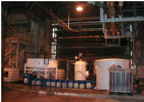
Sistema piloto de oxidación avanzada para tratamiento de fenoles en industria de celulosa.
