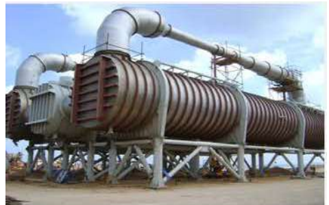
Planta desalinizadora MED con compresión térmica de vapor (MED-TVC) de Zawia Derna Sussa situada en Libia.
