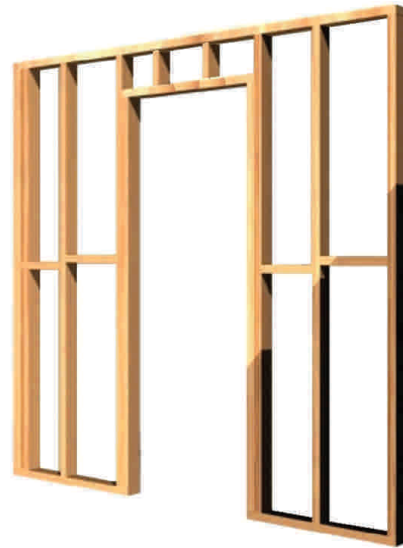
Figura 10 - 3a: Elevación de un tabique autosoportante prefabricado.
