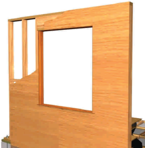
Figura 10 – 2b: Elevación exterior de un tabique soportante estructural prefabricado montado sobre su plataforma base.
