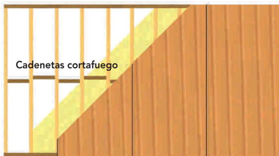
Figura 10 - 26a: Muro arriostrado con tableros contrachapados, pie derecho cada 400 mm en este caso.
