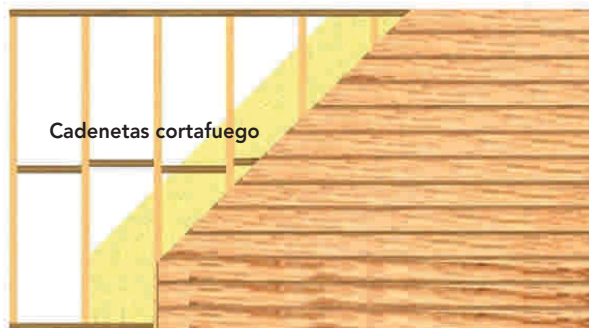
Figura 10 - 25a: Molduras dispuestas en forma horizontal, de características similares a la Figura 10 – 23.
