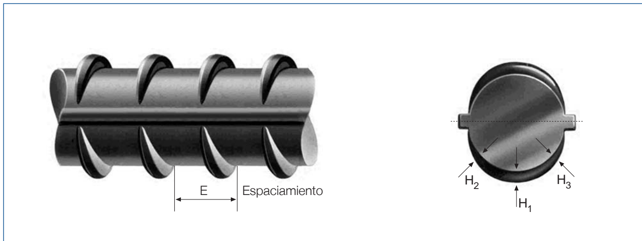
Figura 6.2.4: Esquema de Resaltes en una Barra de Refuerzo para Hormigón Gerdau AZA
