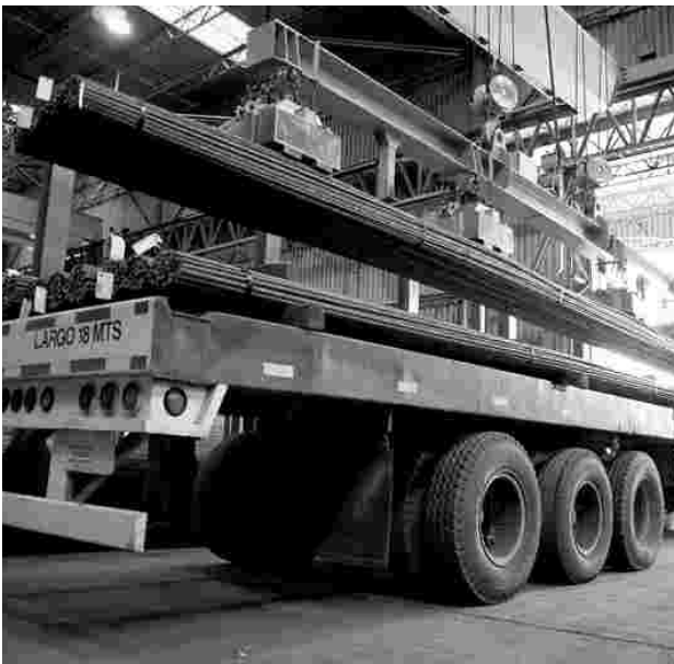
Camión rampa cargado con barras de refuerzo para hormigón.
