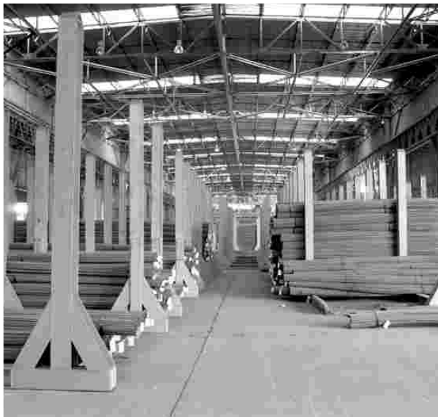
Almacenamiento de Barras de Refuerzo para Hormigón
