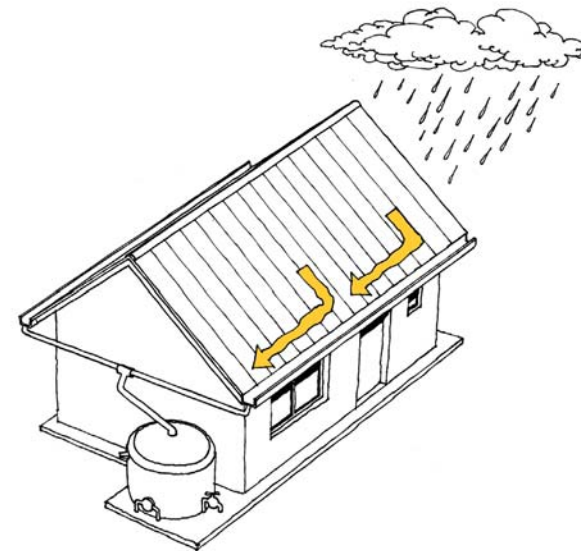
Figura IV.7.2: Sistemas de recuperación de aguas lluvia.
