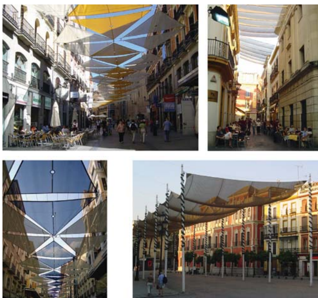
Figura III.2.1.7.3: Toldos protectores en las calles de la ciudad de Madrid y Sevilla (España). Generan sombras en las calles y permiten mantenerlas iluminadas.
